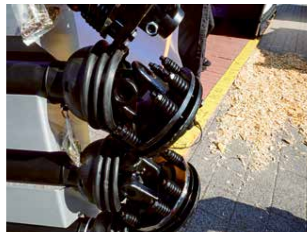
■ Jednym z rodzajów zabezpieczeń są ciernie ze sprężyną talerzową
