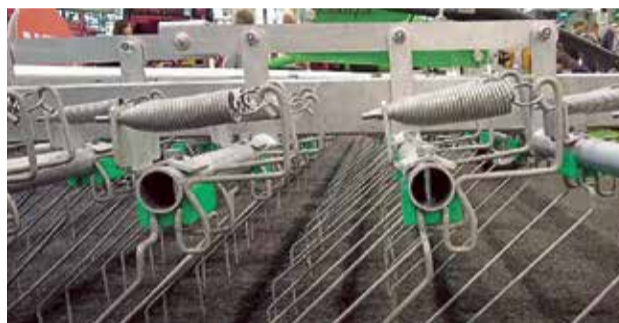
■ Każdy z zębów ma indywidualne zawieszenie na sprężynie
