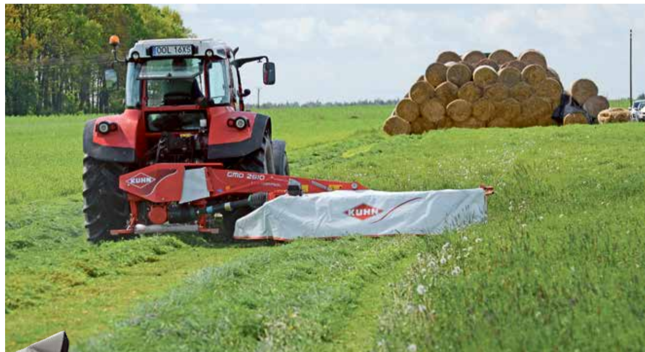
■ Obecnie najczęściej wybieranymi kosiarkami przez rolników są te o konstrukcji dolnonapędowej, czyli tzw. dyskówki
