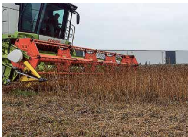
Fot. 2. Zbiór soi kombajnem wyposażonym w kosę typu flex umożliwia zebranie najniższych strąków
