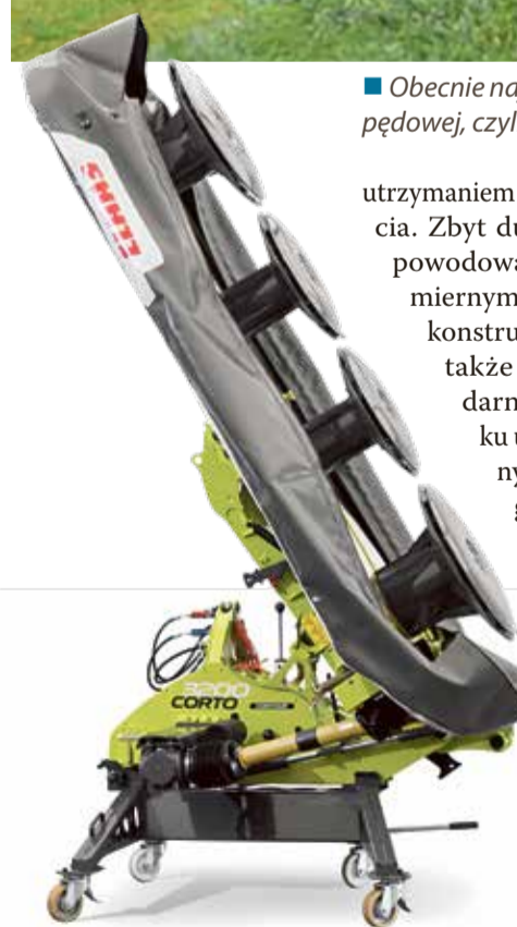
■ Uniwersalność zastosowań oraz prosta konstrukcja sprawiają, że kosiarki bębnowe wciąż znajdują swoje miejsce w ofercie producentów
