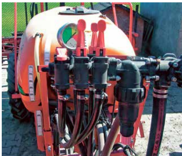
■ Zawory sterująco-rozdzielcze muszą poprawnie działać, być szczelne i charakteryzować się dobrą stabilnością
