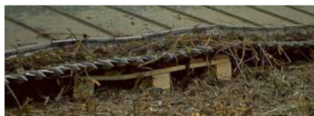
Fot. 4. Heder wyposażony w kosę typu flex do zbioru soi
