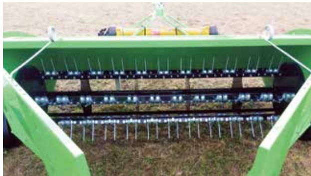
■ Element roboczy przetraszaczo-zgrabiarki, którym jest wał z zamontowanymi sprężynami zębowymi
