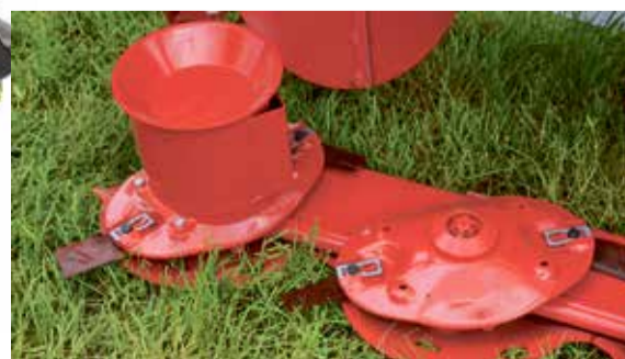
■ Lekka konstrukcja belki tnącej oraz możliwość pozostawiania pokosu na prawie całej szerokości cięcia, to niewątpliwe zalety kosiarek dyskowych
