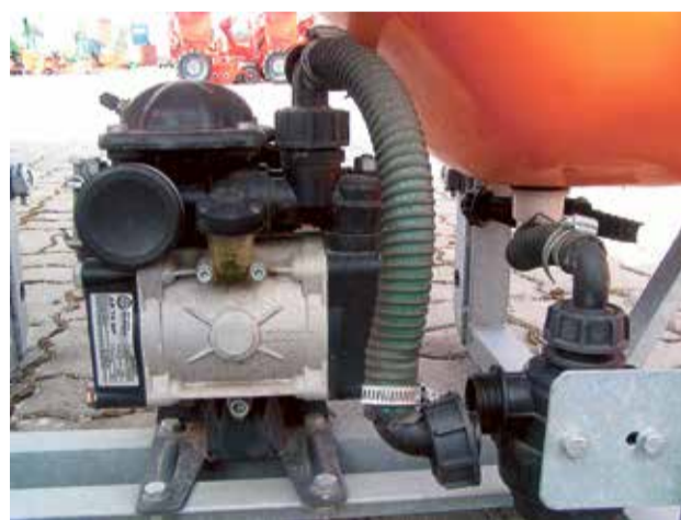
■ Należy dokonywać regularnych przeglądów i podstawowych napraw pompy, m.in. wymiana przepon, sprężyny zaworu itp.
