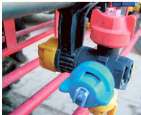
■ Różne rozpylacze zainstalowane na belce, pozwalają na szybką ich wymianę w zależności od warunków
