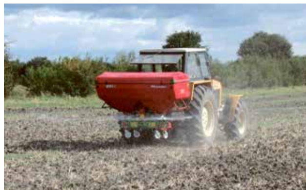
■ Zasadniczy pobór mocy rozsiewacza na napęd tartaczek rozsiewających odbywa się z WOM-u ciągnika
