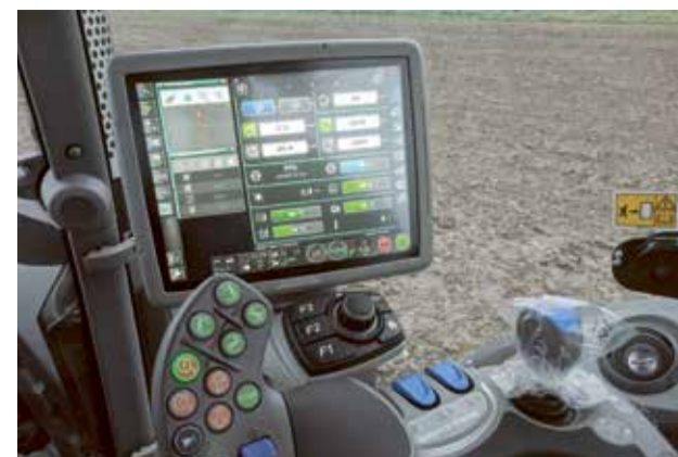
■ Nowoczesne maszyny często wykorzystują zaawansowane komputery sterujące. Technologia ISOBUS pozwala przenieść sterowanie maszynami do jednego terminala, ograniczając tym samym nieporządek w kabinie
