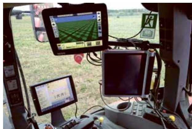
■ Nowoczesne maszyny często wykorzystują zaawansowane komputery sterujące. Technologia ISOBUS pozwala przenieść sterowanie maszynami do jednego terminala, ograniczając tym samym nieporządek w kabinie
