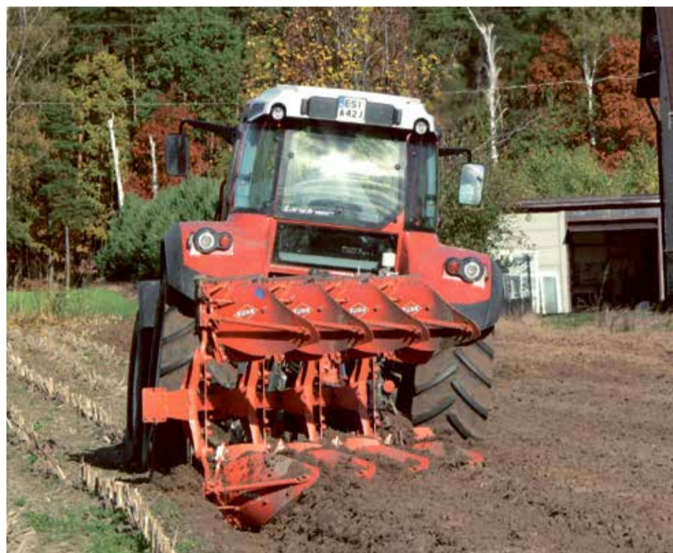
■ W pracach polowych z plugiem obrotowym czy też z agregatem uprawowo-siewnym, najbardziej doskwiera brak odpowiedniego zbalastowania ciągnika oraz jego niewielkie gabaryty
