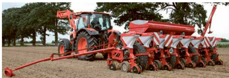
Podstawą w nowoczesnej koncepcji siewu punktowego są siewniki wyposażone w elektroniczne sterowanie i elektryczny napęd sekcji wysiewających, co zwiększa precyzję siewu i wydajność pracy oraz poprawia komfort obsługi
