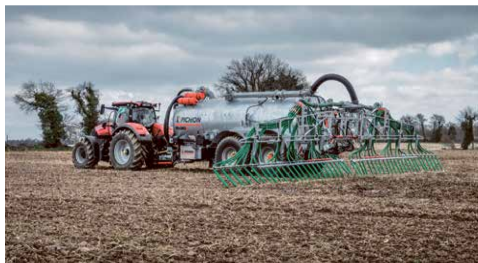
■ Nowa seria wozów asenizacyjnych Pichon SV może być wyposażana w różnego rodzaju aplikatory: belki z węzami wleczonymi, łyżwowe, tarczowe i tarczowe fot. materiały prasowe
