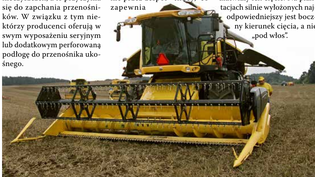
Adaptacja przyrządu żniwnego kombajnu zbożowego do zbioru traw i motylkowych drobnonasiennych w zasadzie polega na zdemontowaniu rozdzielaczy łanów.
